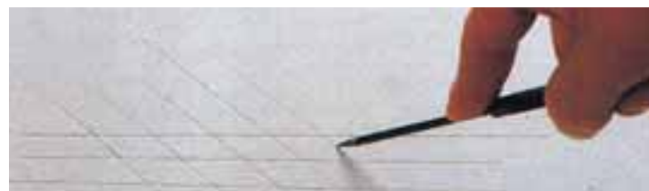
2 Ritzprobe bei Estrichen (Knauf-Bodenverlegung 2001)
