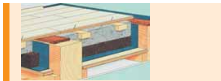
19 Holzfußboden erneuern (Agentur 21-2002)
