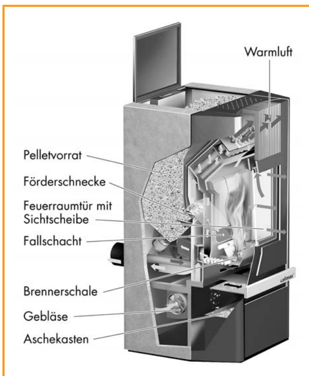
Abb. 2-1: Beispiel eines Pelletofens (Warmluftgerät) (Grafik: calimax)
