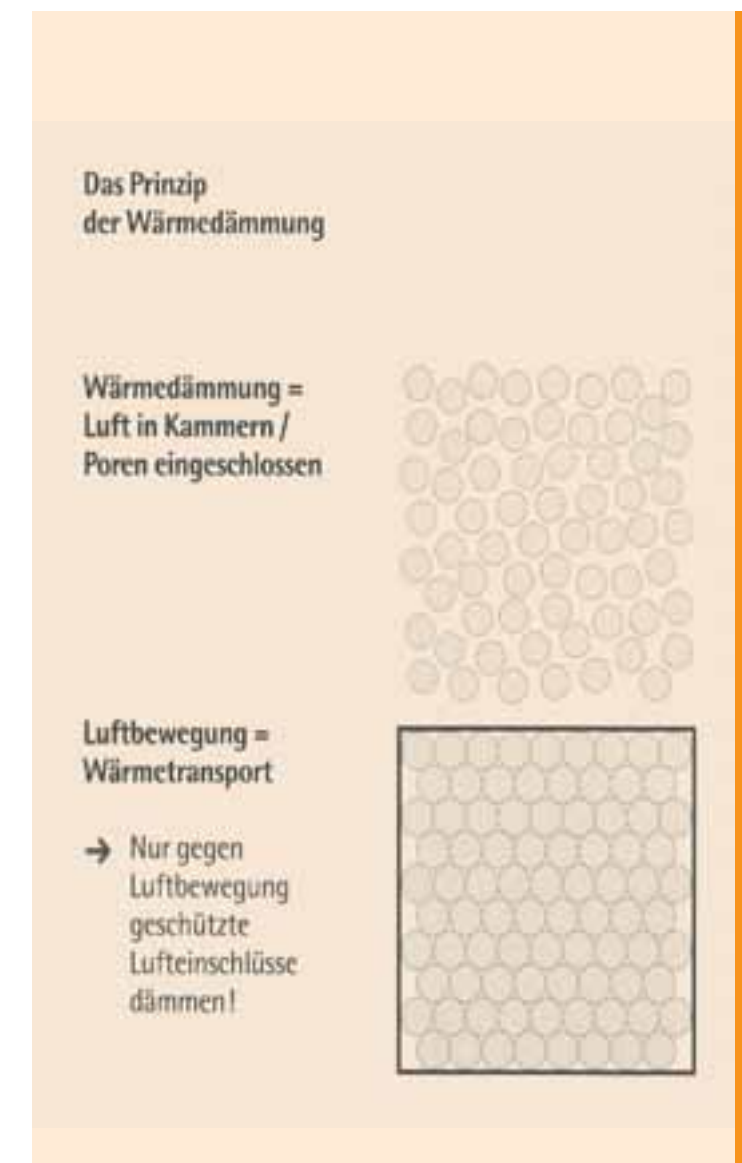
1 Das Wirkungsprinzip der Wärmedämmung (B.I. Moll)
