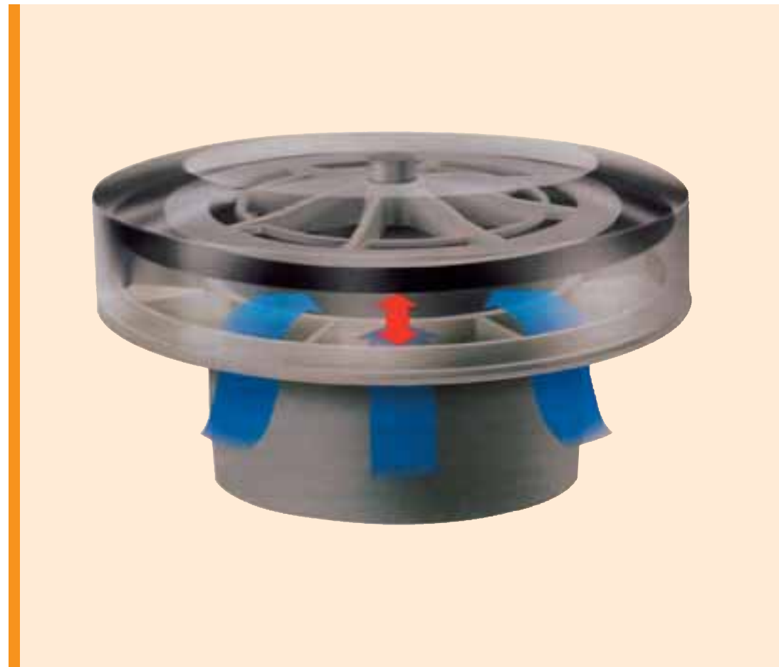
15 Rohrbelüfter auf einem Fallrohr im Installationsschacht des Dachgeschoss ersetzen die Durchführung durch das Dach. (quadriga, 1/2001)
