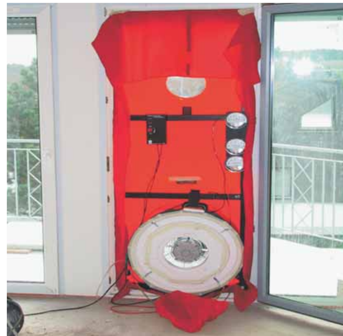
6 Blower-Door-Test: Die Messein- richtung
